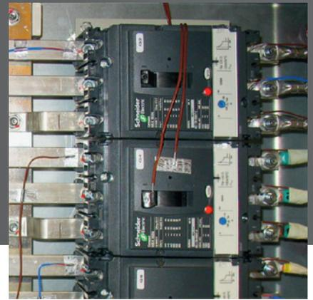
différenciées par le nombre d'essais entraînant des limites d'utilisation des résultats. Les mesures de températures de l'ENSEMBLE testé se font aux endroits où une limite d'échauffement doit être observée (organes de commande, surfaces accessibles, bornes de raccordement, ...). L'air ambiant va être mesuré simultanément à 1 m de l'ENSEMBLE.
