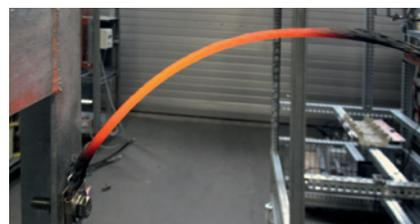
section de 100 x 5 mm<sup>2</sup> une élévation de température de plus de 50°C (on passe de 40 °C à plus de 90 °C).
